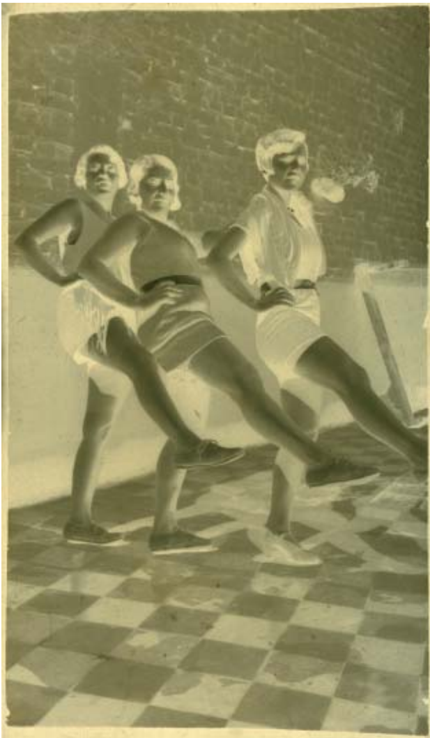
▲ Negativo em base de nitrato de Celulose. Imagem em perfeito estado. A base apresenta coloração marrom típica Dos negativos em nitrato.
